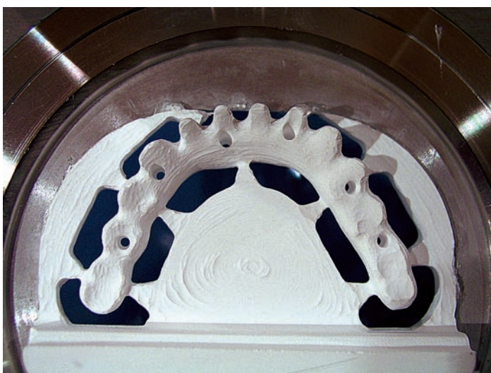
7) Bridge implantopéré après fraisage.
