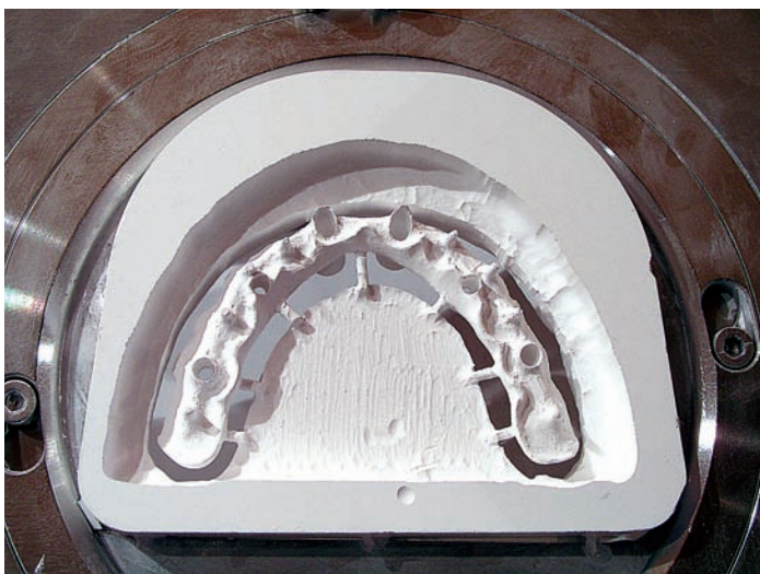
18) Le bridge implanto-porté destiné à une finition en résine après fraisage dans la zircone crue.
