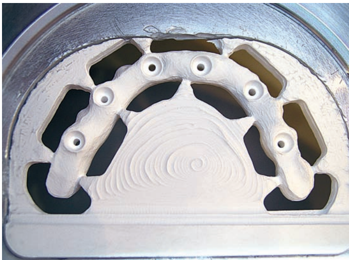
6) Bridge implantopéré après fraisage.
