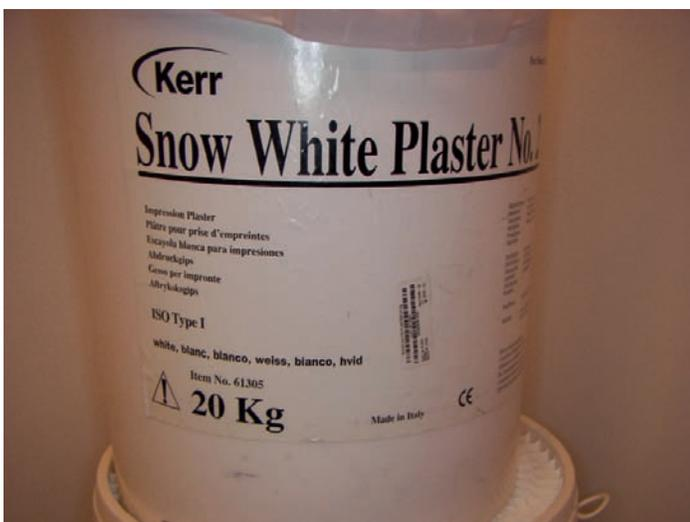
Fig. 14 : Snow White® : plâtre à faible expansion de prise
